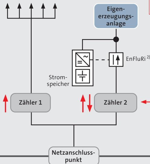
gem. Messstellenbetriebsgesetz (MsbG) wird ein intelligentes Messsystem (iMS) bei einem Jahresstromverbrauch > 6.000 kWh oder einer installierten Leistung > 7 kW erforderlich, wenn zertifizierte iMS verfügbar und dementsprechend einsetzbar sind.
